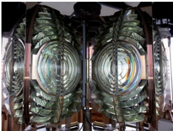
► Les optiques du phare d'Eckmühl sont composées de deux lentilles de Fresnel à quatre panneaux.
